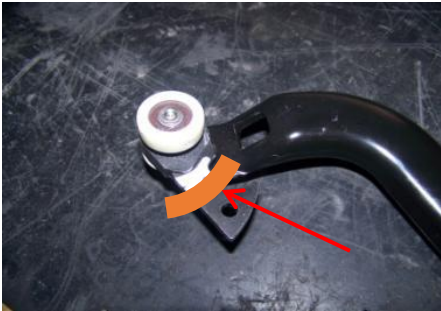
Alt ayak kancası sol üst resimde görüldüğü üzere işaretli yerden tamamen kesildikten sonra, ayak brakete geri takılır.
